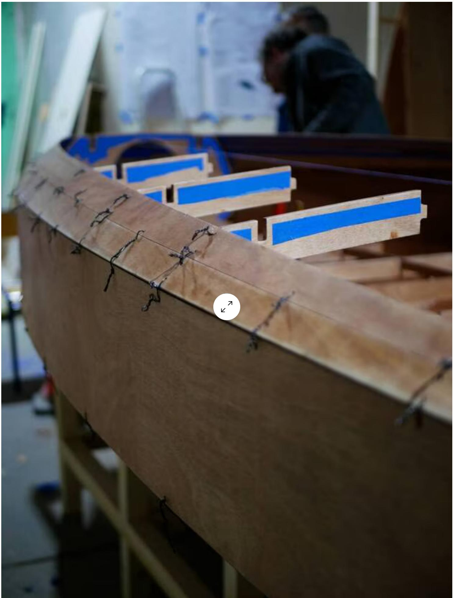
La technique du cousu collé, avant que les fils de fer ne soient retirés. | NINON ROULIN
