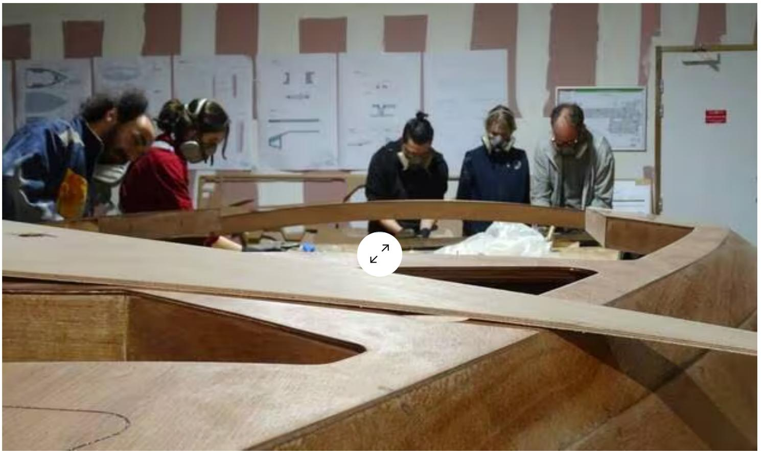
Le bateau est conçu à partir de très fines plaques de contreplaqués, de trois épaisseurs : quatre millimètres (les virures), neuf millimètres (la charpente) et 20 millimètres (le marbre). « Cette finesse nous permet de tordre les plaques, pour les caler dans les encoches », détaille Louis, stagiaire. | GAËLLE LEBOURG
